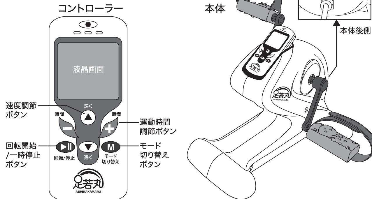
※回転/停止ボタン とモード切り替えボタン は動作中に押すとただちに動作を停止する『緊急停止ボタン』です。
